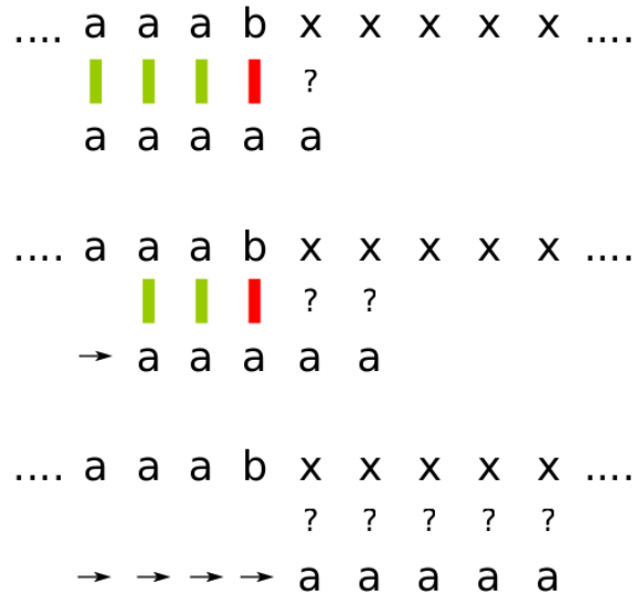
Figure 4.1: Dall'alto. Mismatch al quarto confronto nell'attuale allineamento. Uno shift del pattern di una posizione genera in modo predicibile un mismatch al terzo confronto. Il prossimo allineamento con possibilità di successo si ha solo con uno shift di quattro posizioni del pattern sul testo.
