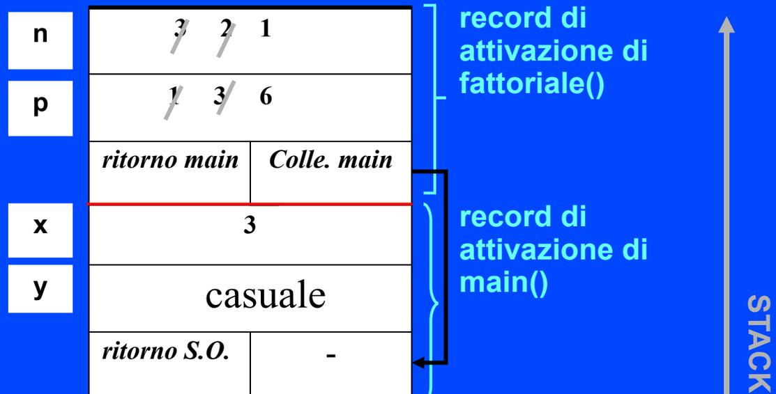
La figura illustra la situazione nello stack nel momento di massima espansione, quando la funzione sta per terminare. Quando la funzione *fattoriale()* termina, il suo record viene deallocato e il risultato viene trasferito nella cella di nome *y* col seguente meccanismo
